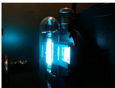
Foto di una lampada al cadmio utilizzata come riferimento di lunghezza d'onda.
